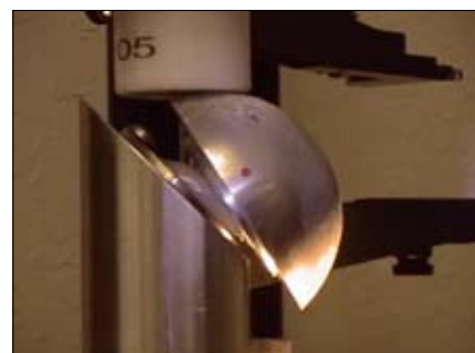
Abb. 3: Testversuch unter 45°-Scherbelastung
